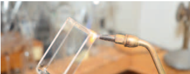
Abb. 9) Die Glasoberfläche wird mit Spitzenflammen effektiv verschlossen.
