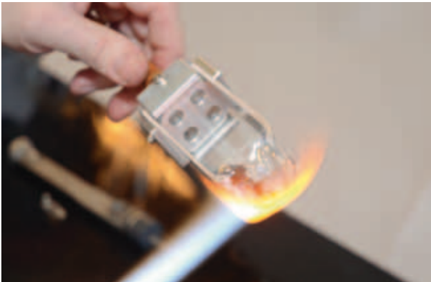
Abb. 7) Jetzt ist der Glasbehälter soweit um das Füllrohr auf zu schmelzen.
