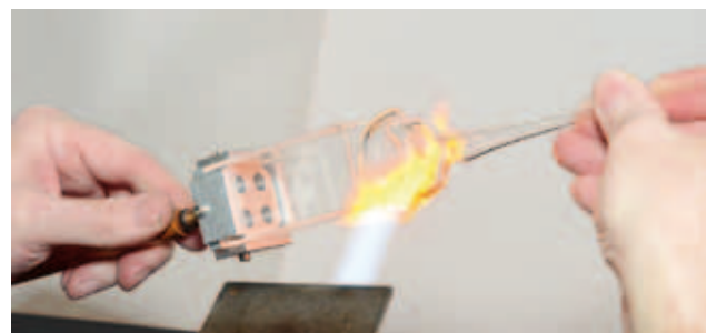
Abb. 4) Nach dem Erwärmen wird die Öffnung mit einem Rohr verschlossen.
