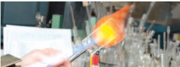
Abb. 10) Während des ganzen Vorgangs ist die Glasoberfläche mit einer sehr weichen Flamme zu wärmen, damit nicht plötzlich Spannungen entstehen und das Glas zerspringt.
