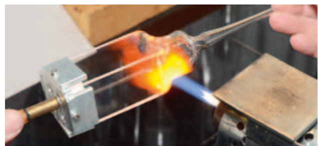
Abb. 6) Der Behälter wird durchgeheizt.
