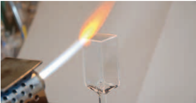
Abb. 8) Nach dem Entfernen der Metallhalterung und dem Auflegen der Bodenplatte, beginnt die Bearbeitung des Bodens.
