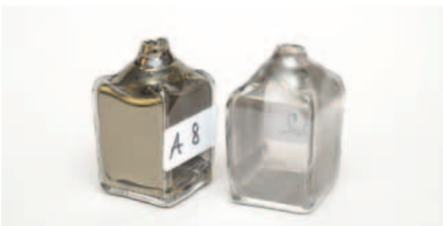
Abb. 1) Fertiges Modell, gefertigt aus Borosilikat 3,3 Glas mit physikalischen Massen 35x35x70mm. Bereit zum Auffüllen und Schließen.
