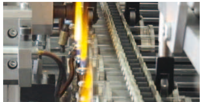
Kontinuierlich arbeitender Flachläufer bei der Produktion von Linsenkolben
