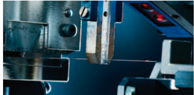
Der mechanische Greifer entnimmt einen Draht aus der Vereinzelungsvorrichtung
