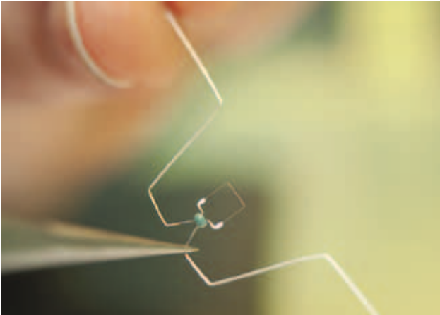
Fuß mit gestrecktem Glühfaden für Skiaskope
