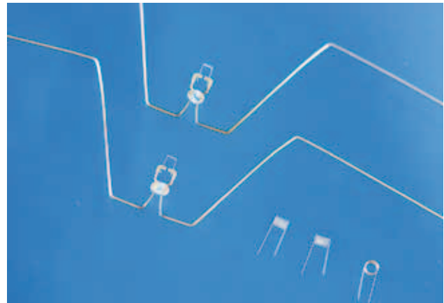
Fertige Füße mit aufgequetschter Wendel
