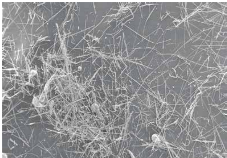
Künstliche Mineralfasern im Rasterelektronenmikroskop
