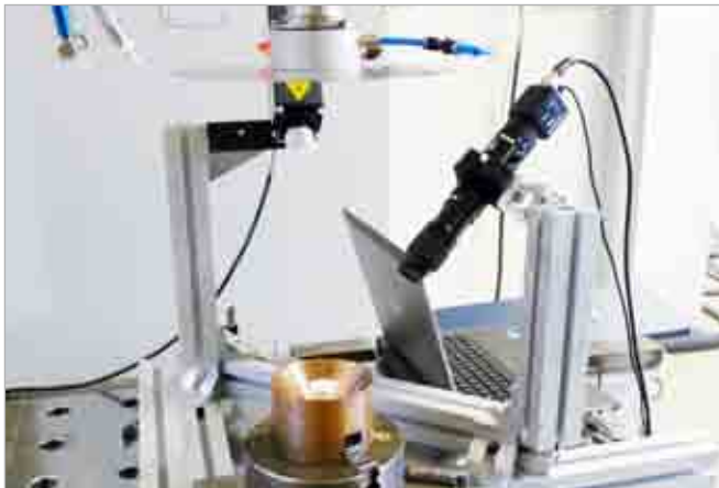
Laserlöten, Versuchsaufbau und Prozess
