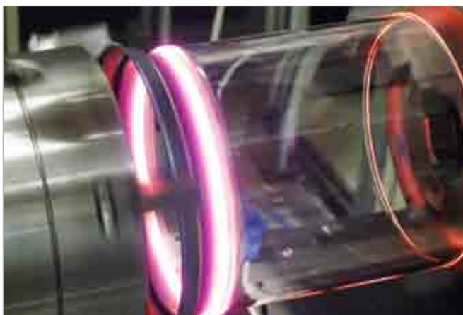
Glas-Metall-Verbindung, Prozess und Verbindungszone
