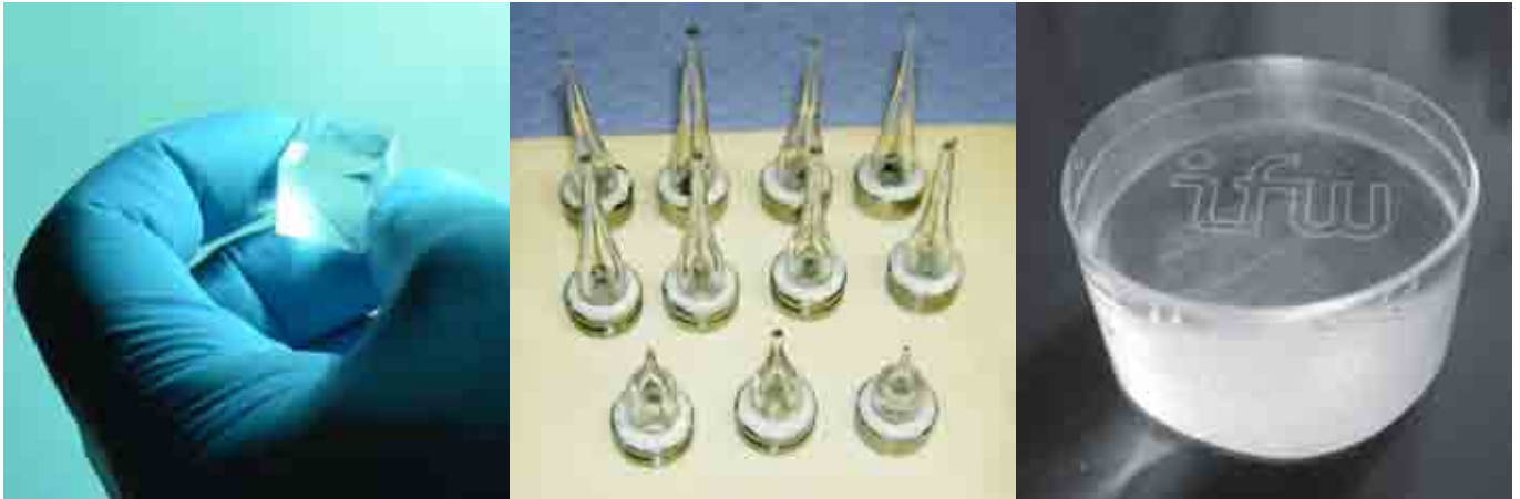
Kleben, Löten (Kovar-Pyrex), Diffusionsschweißen (BK7)
