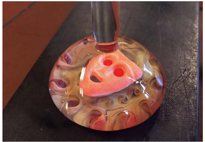
Maske eingeschlossen in heißes Boro 3.3
