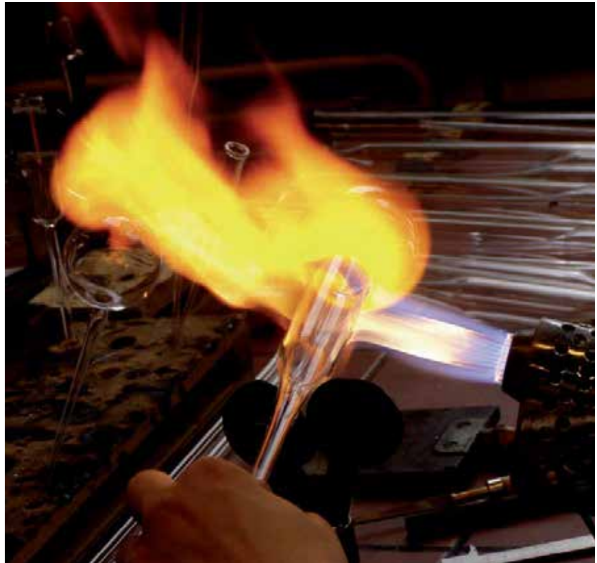
Abbildung 1: Bearbeitung von Glas an einem Tischbrenner
