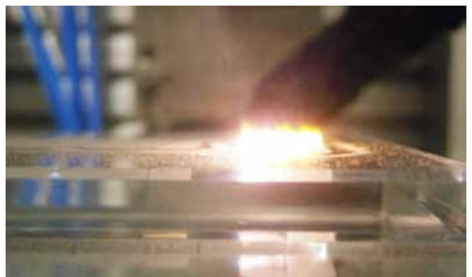
Laserabtrag an BK7 mit KP-CO 2 -Laser
