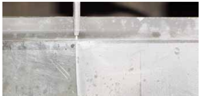
Wasserstrahlschneiden von Borosilikatglas d=80mm
