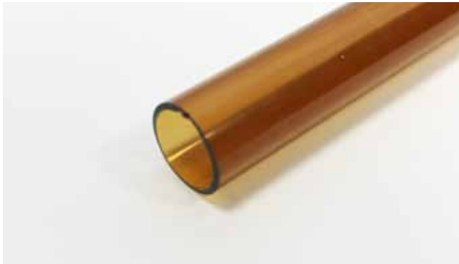
Mit Laser abgesprengtes Fiolaxrohr (Ø12 x 1 mm)
