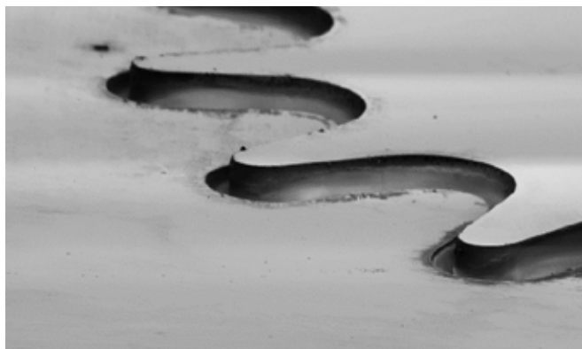
Quarzglaszahnrad, Zahnhöhe 1 mm
