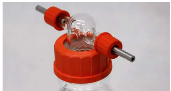
Ein moderner Klassiker – die Gaswaschflasche basiert auf einer Laborschraubflasche. Hier allerdings ohne Schlaucholive – sondern nach Kundenwunsch mit 6 mm Stahlrohr als Übergang zu Swagelok-Verschraubungen.
