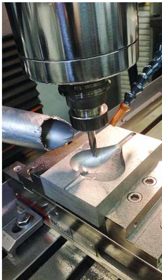
Bearbeitung einer Einblasform von ANDRÄ Graphit
