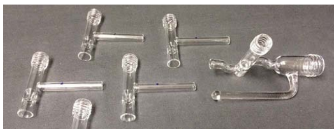
Ventile für die Vakuumleitung
