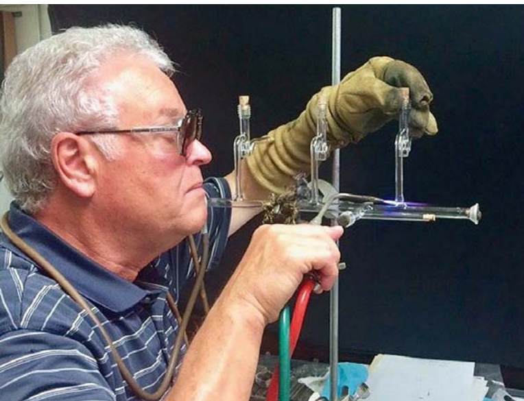
Joe Gregar beim Bau der Schutzgasleitung
