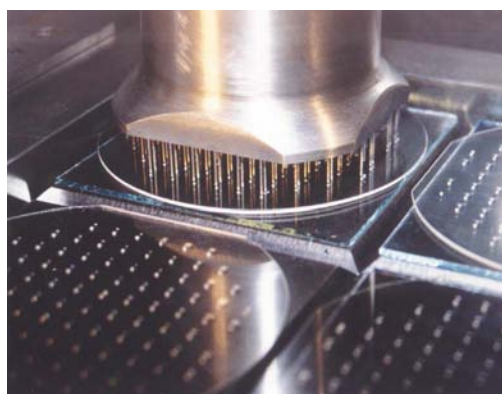
Glaswafer Bearbeitung mit Mehrfachwerkzeug
