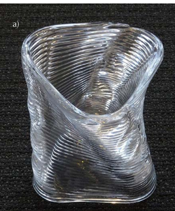
Abbildung 1: Additiv gefertigte Glaskomponenten: a) „3D-gedrucktes“ Glas (FDM) vom MIT [3] (Foto U. Knaack); b) „3D-gedrucktes“ Borosilikatglas auf Flachglas
