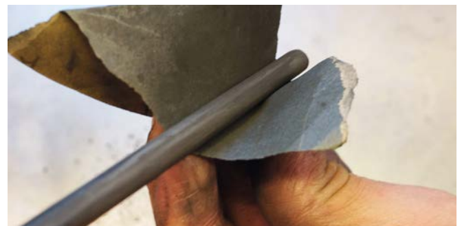
Diese wird mit einem Schleifpapier (Körnung 320) abgeschliffen.
