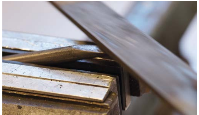
Bearbeitung der Rundkohle im Schraubstock mit einer Feile.
