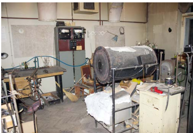
Blick in die Werkstatt: Der große, runde Zylinder ist ein vertikaler Ofen zum tempern für große Dewargefäße.
