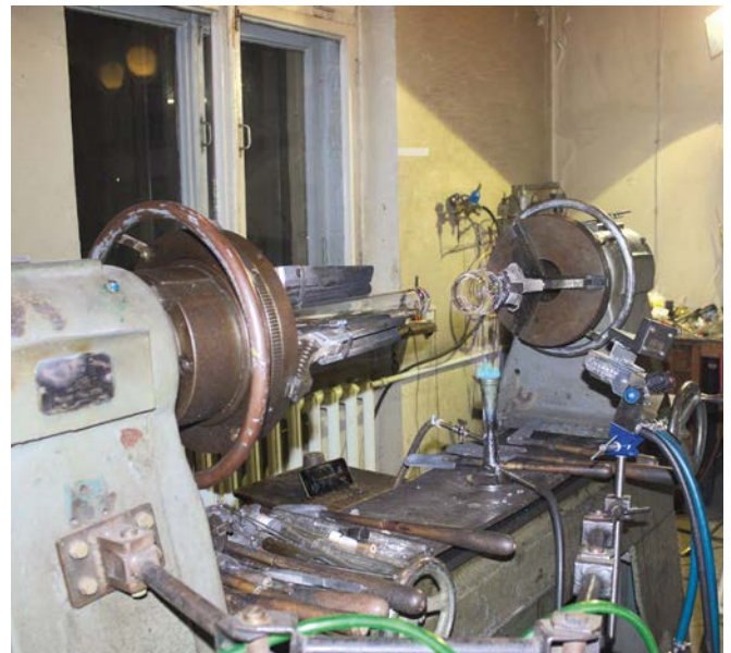
Drehbank mit aktualisiertem, linken Backenfutter
