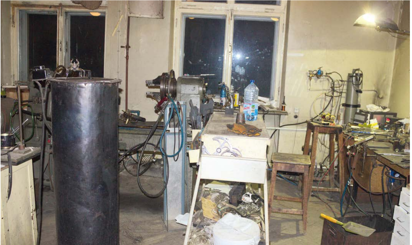
Blick in die Werkstatt: Der große, runde Zylinder ist ein horizontaler Ofen zum Tempern für große Dewargefäße.
