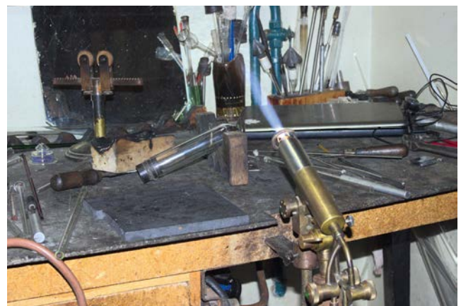
Ein Tischbrenner mit nachgeschliffenen Ventilen, der nun mit Propan genutzt werden kann.
