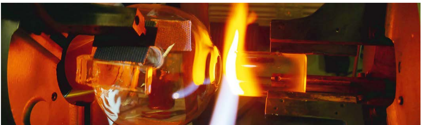
Fertigen des Bodens und das Beheben eines Fehlers
