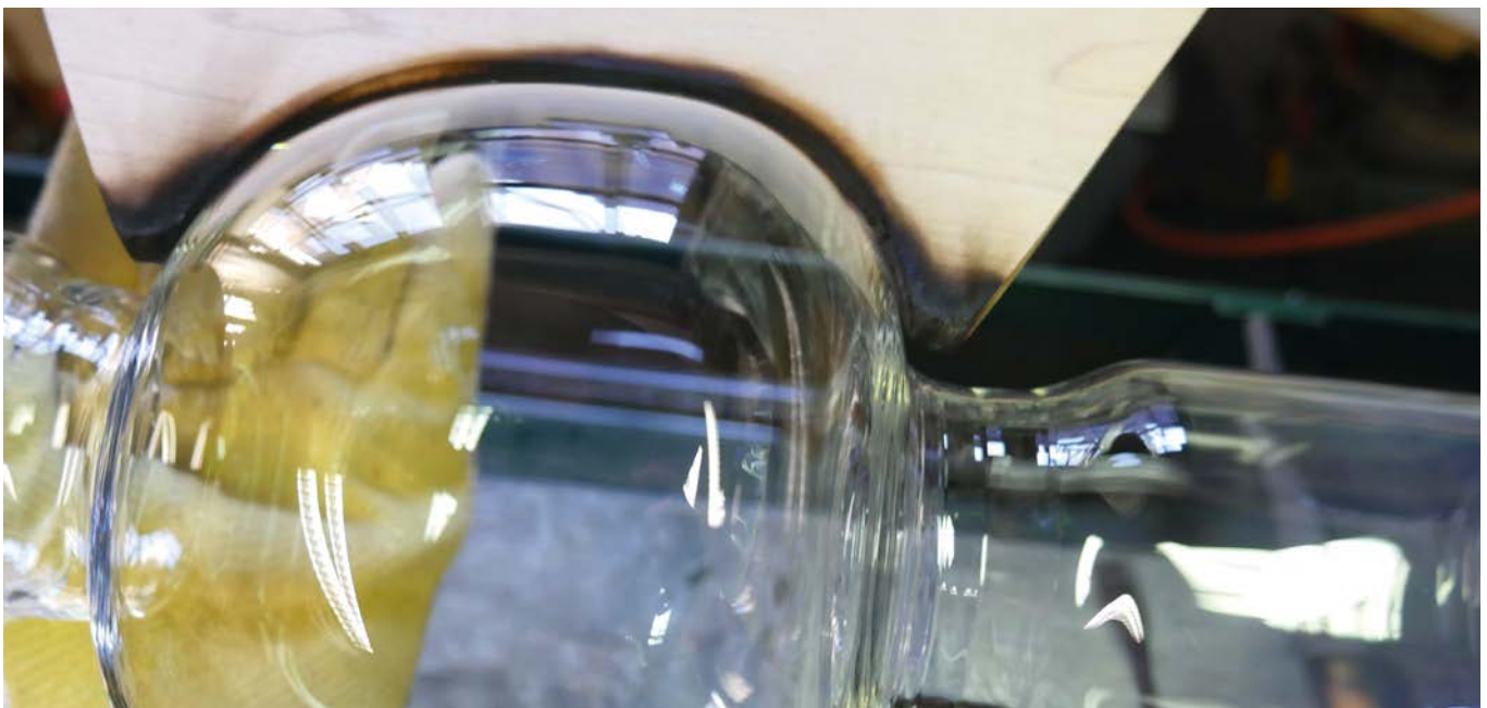
Einrollen des Teekannenkörpers in die Holzform
