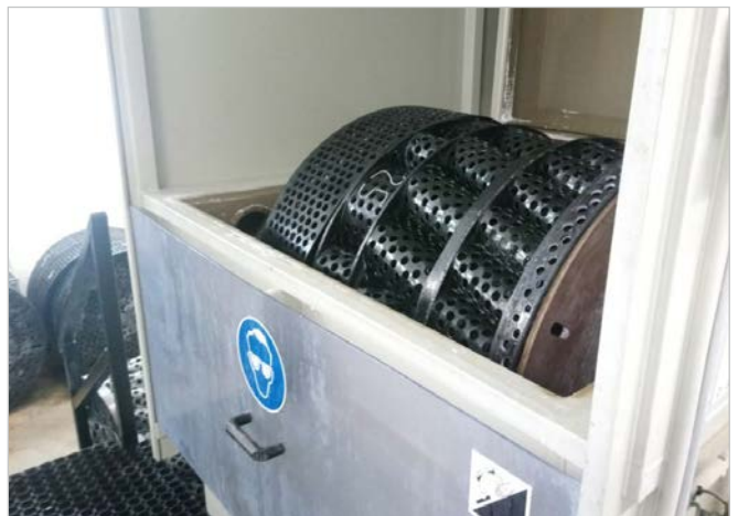
Der Korb wird nun durch eine konstante Drehbewegung bei mehreren Spülgängen für 1,5 - 2,5 Stunden (abhängig von Wandstärke der Glasartikel) im Säurebad blank poliert.
