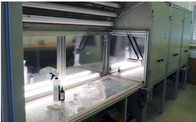
Spülmittel, UV-Kleber und Werkstück zur Anschauung, in der mit UV-Lampen ausgestatteten Box
