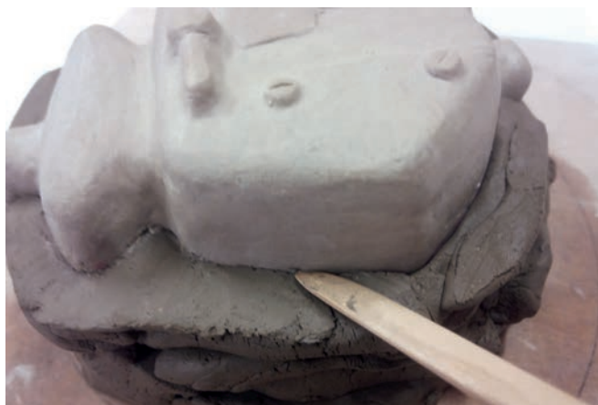
Das Tonbett muss lückenlos an der Tonform anliegen
