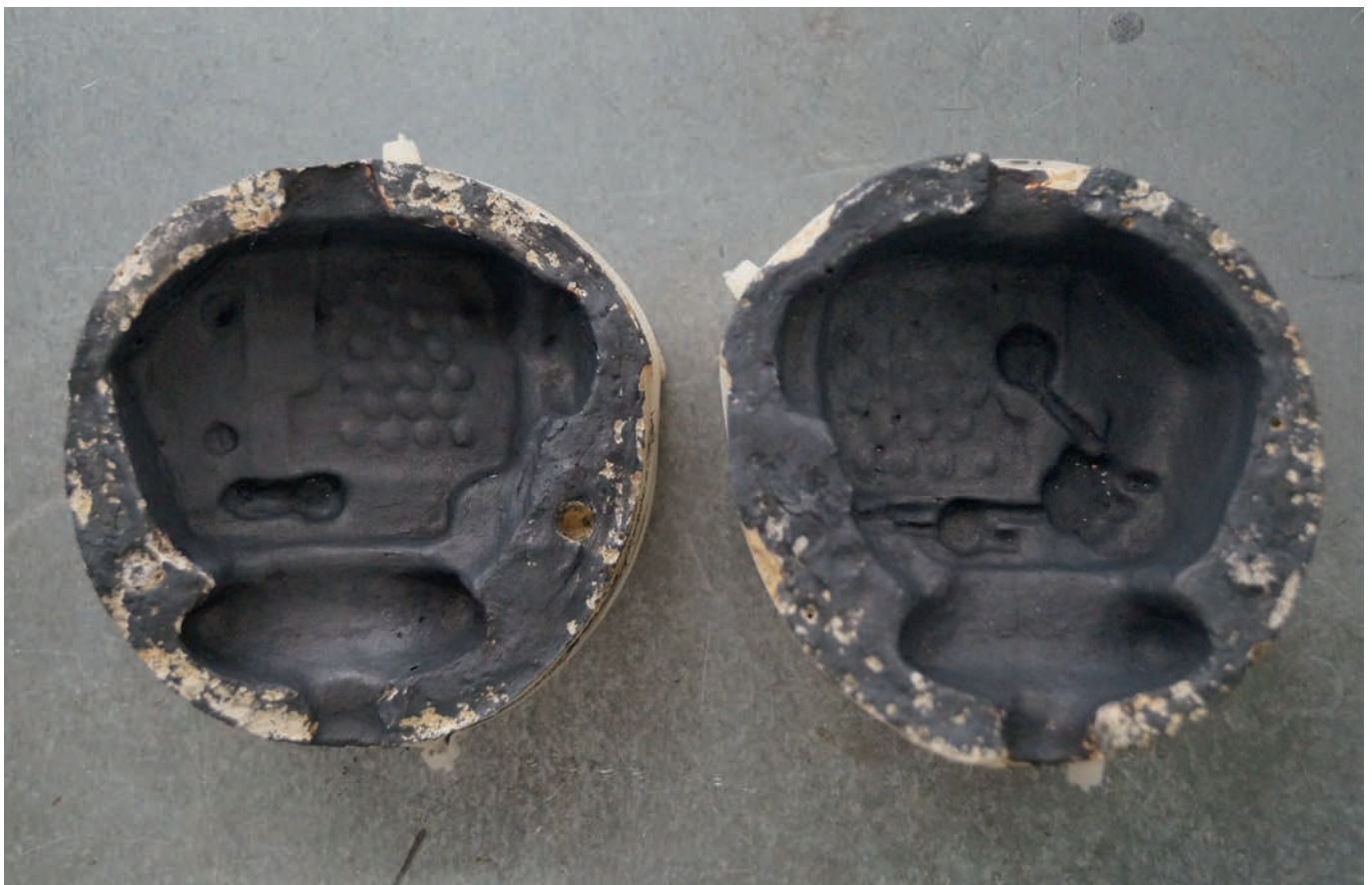
Die fertige Form bestrichen mit Graphit als Trennmittel
