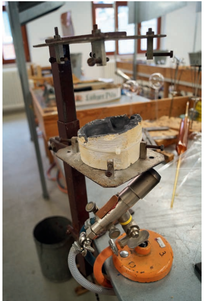
Fußformzange am Arbeitstisch montiert, mit zum Teil eingespannter Form
