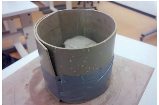
Der Fußbodenbelag, doppelt so hoch, als auslaufsichere Umrandung
