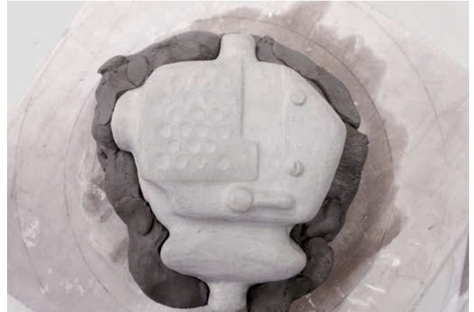
Die Ansätze für die Handhaben schließen jetzt genau mit dem Rand der Tonplatte ab.
