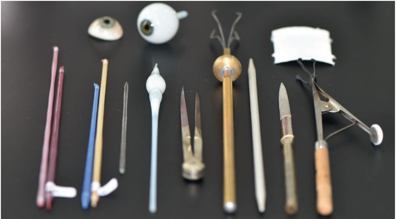
Werkzeug und Material zur Herstellung einer Prothese: verschiedenes Adernrot, gelbe und blaue Fett-Farben, Anhefter, Spieß zum Ansetzen, Stechzirkel, Kugelhalter, Stricknadel, Diamantfeile, Spezialzange, Zellstoffpapier, halbfertiges Muster
