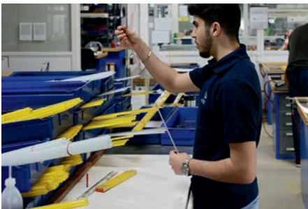
Auszubildender bei der Endmaßkontrolle der Instrumente
