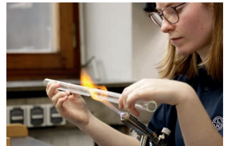
Glasröhre für Einschlussthermometer heiß verformen
