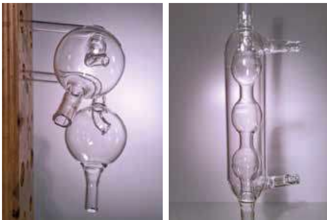
Fertigung von Spritzschutz und Kugelkühler nach Zeichnung
