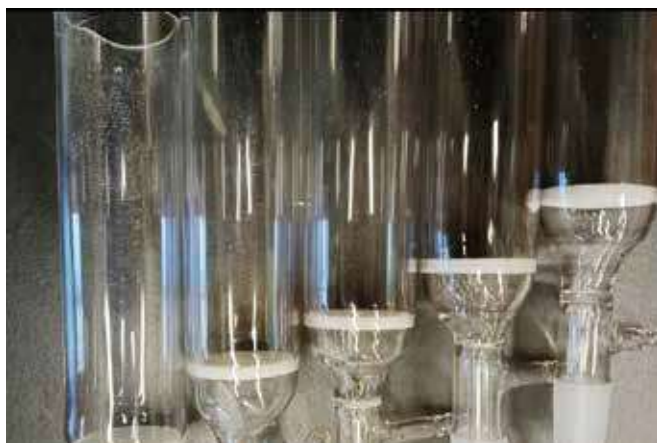
Dominika erlernt an der Uni Oldenburg das Einschmelzen von Filterplatten
