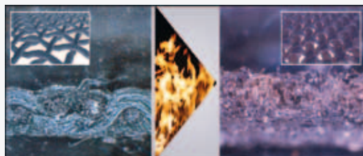
Funktionsweise von Nomex®: Bei Flammenbeaufschlagung verdichtet sich Nomex® und absorbiert Energie, wodurch weniger Hitze auf die Haut durchgeleitet wird.
