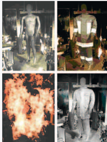
Ein Beflammungstest am DuPont™ Thermo-Man® schafft Gewissheit darüber, wie leistungsfähig die Hitze- und Flammenschutzkleidung aus Nomex® ist.
