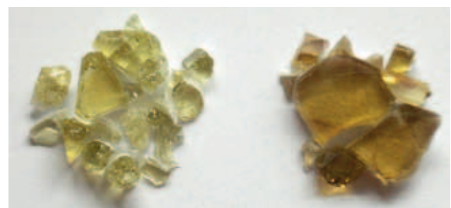
Abbildung 4: Nach historischem Rezept geschmolzenes Glas/ links Schmelze1, rechts Schmelze 2. (Foto: Ralf Greiner)
