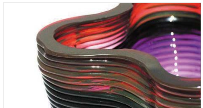
Abbildung 2: Durch FDM gefertigtes Bauteil [2]
