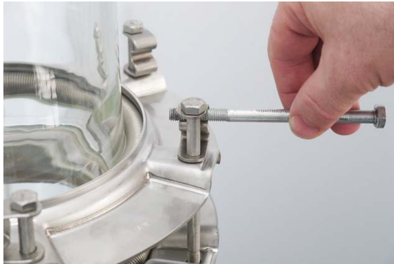
Den Potenzialausgleich können Anwender ohne großen Aufwand mit Metallflanschen durchführen
